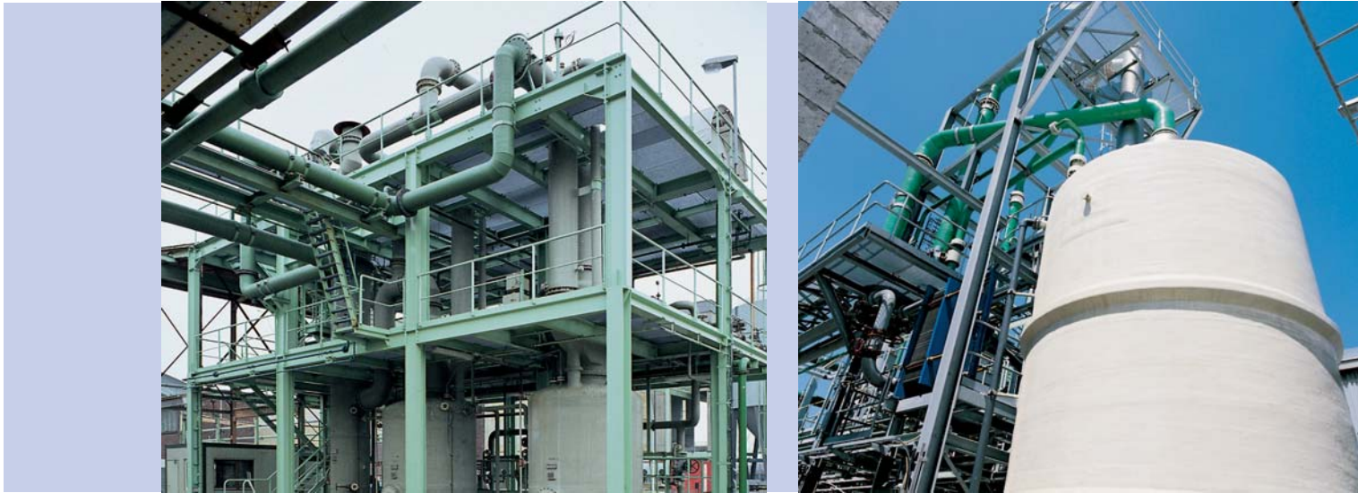
左图: 氯气吸收装置用于清洗来自氯碱电解工艺和氯气漂白生产的废气
