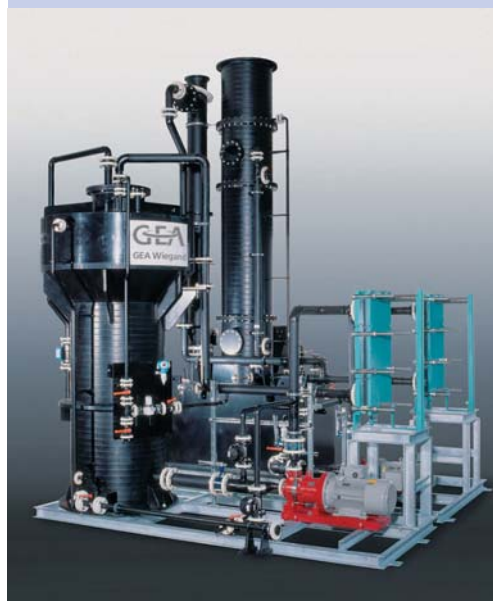
喷射洗涤装置类型 II 用于酸性和碱性废气
