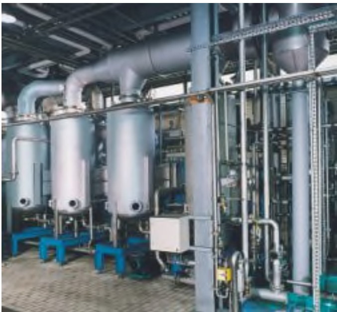
Planta de evaporación con intercambiador de placas de efecto múltiple para fructosa. Caudal de evaporación: 16 t/h
