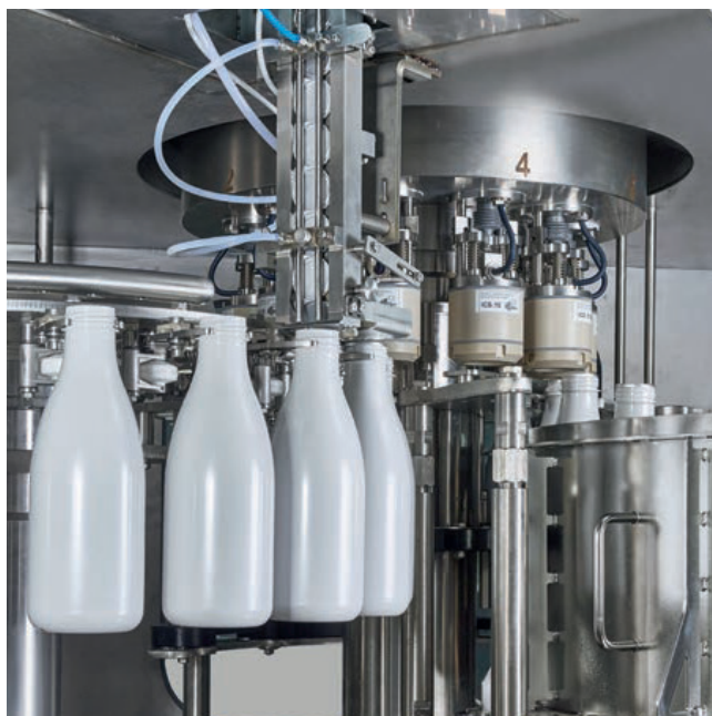
Запатентованная GEA конструкция барабана системы индукционного запаивания — это техническое решение обеспечивает возможность полной гигиенической очистки и стерилизации.
