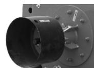
Garde de sécurité pour l'arbre de transmission de la prise de force (modèle européen)
