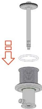
Abb.63: Dichtung und Achse einbauen
