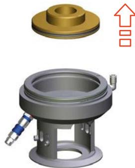
Abb.96: Kolbenteller herausheben
