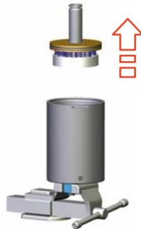
Abb.92: Oberes Federpaket herausheben
