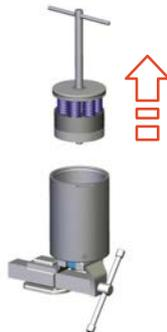
Abb.93: Unteres Federpaket herausheben
