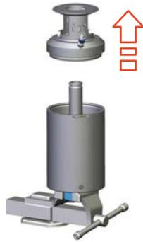
Abb.91: Antriebsunterteil entfernen
