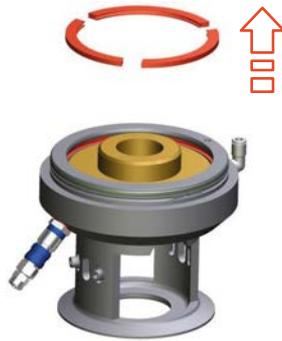
Abb.95: Sicherungselemente entfernen
