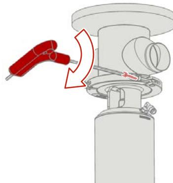
Abb.41: Innenteil zentrieren und befestigen
