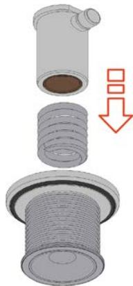
Abb.61: Hülse und Feder einsetzen
