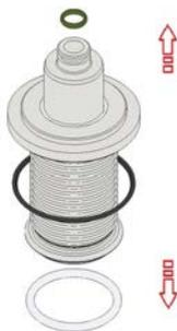
Abb.66: Balgeinheit, Dichtungen demontieren
