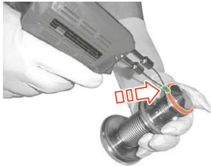
Abb.65: Ventilsitzdichtung auftrennen
