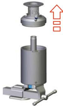
Abb.84: Antriebsunterteil entfernen
