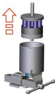
Abb.85: Federpaket herausheben
