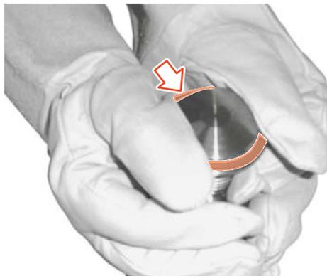
Abb.69: Ventilsitzdichtung aufziehen
