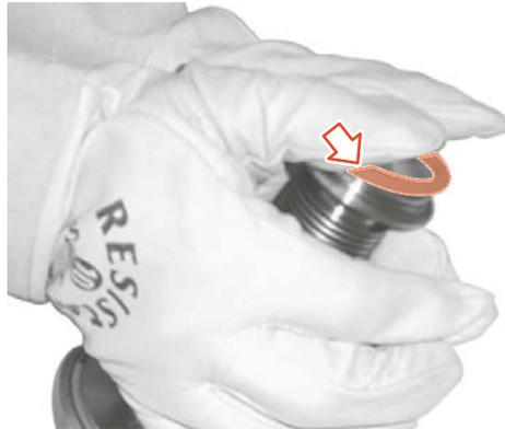
Abb.68: Ventilsitzdichtung in Nut platzieren
