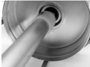
Abb. 37 GLRD-Einbauhülse
