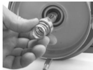
**Abb. 22** Gleitringdichtung
