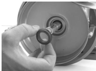
**Abb. 23** Stationär Teil Gleitringdichtung
