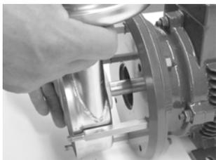
**Abb. 33** Druckgehäuse
