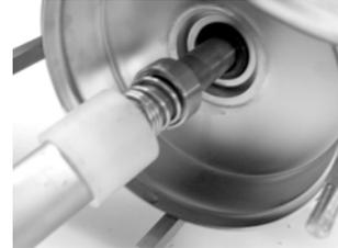
Abb. 38 Gleitringdichtung
