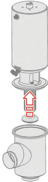
Abb.19: Antrieb und Innenteil entfernen
