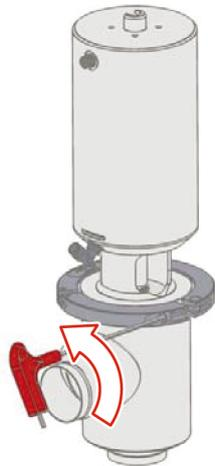
Abb.18: Clampschraube lösen
