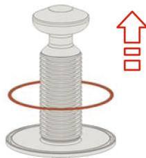
Abb.22: Gehäusedichtung entfernen
