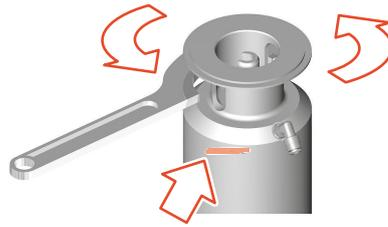
Fig.61: Desserrer le ressort de montage
