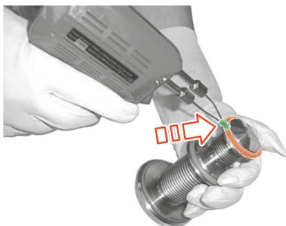
Fig.40: Séparer le joint de vanne à siège
