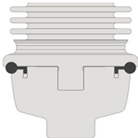
Fig.7: Système "divisible" pour des matériaux d'étanchéité en élastomère
