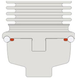
Fig.6: Système "divisible" pour des matériaux d'étanchéité durs
