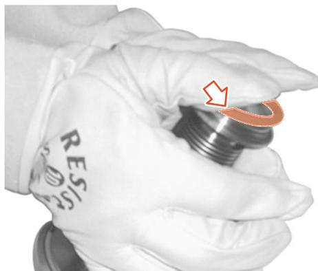
Fig.42: Placer le joint de vanne à siège dans la rainure
