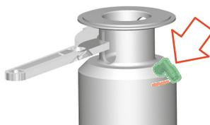
Fig.69: Positionner le raccord d'air
