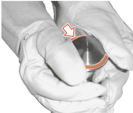
Fig.43: Insérer le joint de vanne à siège
