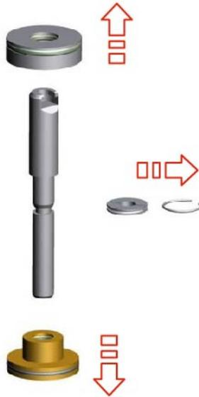
Abb.49: Sicherungselemente und Antriebskomponenten entfernen
