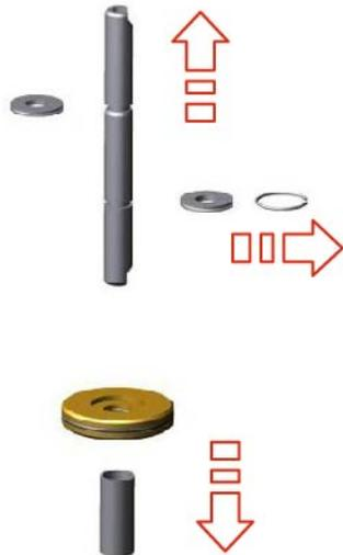
Abb.54: Sicherungselemente und Antriebskomponenten entfernen
