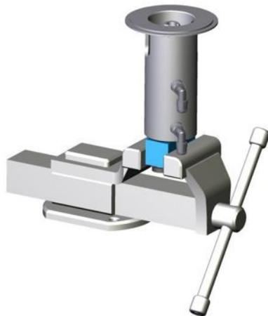
Abb.46: Klemmstück in Schraubstock einspannen
