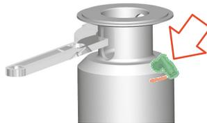
Abb.59: Luftanschluss platzieren
