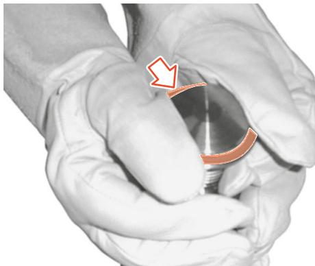
Abb.37: Ventilsitzdichtung aufziehen
