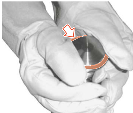
Fig.92: Colocación de la junta de asiento de la válvula
