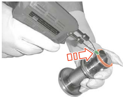
Fig.89: Extracción de la junta del asiento de la válvula
