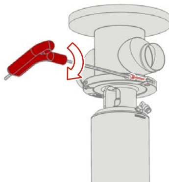
Fig.56: Colocación del semianillo suelto
