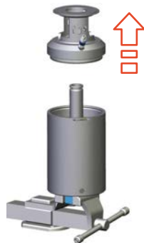
Fig.105: Rimozione della parte inferiore dell'attuatore
