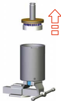
Fig.106: Sollevamento del pacchetto di molle superiore
