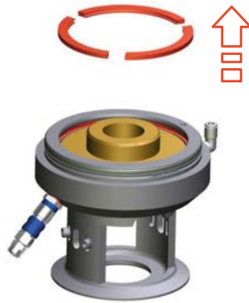
Fig.109: Rimozione degli elementi di fissaggio
