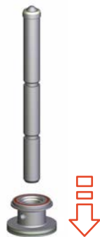
Fig.69: Estrazione della parte inferiore dell'attuatore
