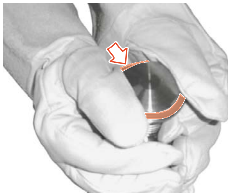
Fig.86: Applicazione della guarnizione della sede della valvola
