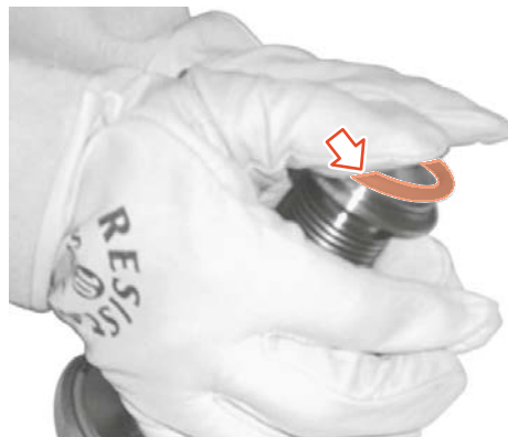
Fig.85: Posizionamento della guarnizione della sede della valvola nella scanalatura
