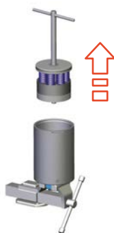
Fig.107: Sollevamento del pacchetto di molle inferiore
