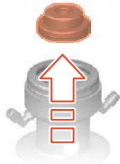
Fig.120: Estrazione del disco dello stantuffo
