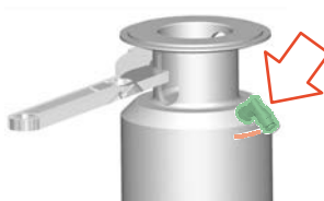
Fig.115: Posizionamento dell'allacciamento dell'aria
