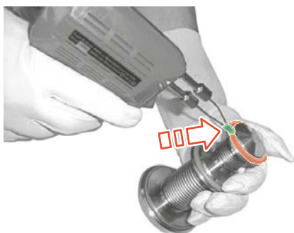
Fig.83: Taglio della guarnizione della sede della valvola
