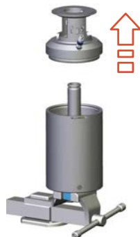
Fig.96: Retirar la parte inferior del accionamiento
