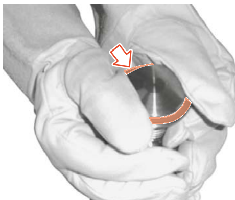
Fig.84: Colocación de la junta de asiento de la válvula
