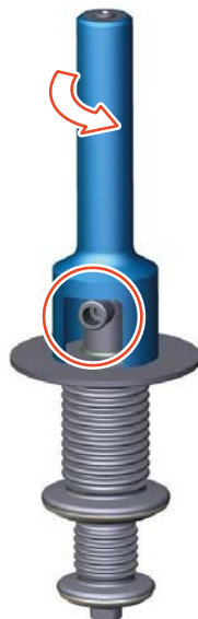
Fig.89: Alinear la abertura al racor de fuga
