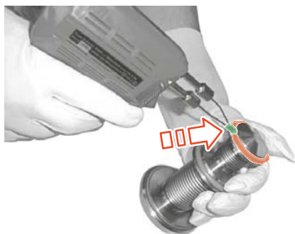
Fig.81: Extracción de la junta del asiento de la válvula
