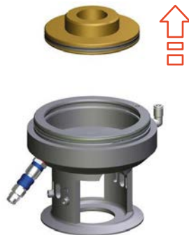
Fig.101: Elevar el disco del émbolo
