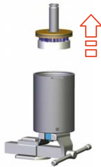
Fig.97: Extraer el bloque de muelle superior
