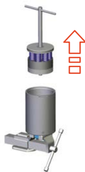
Fig.98: Extraer el bloque de muelle inferior
