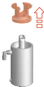
Fig.71: Retirar la parte inferior del accionamiento
