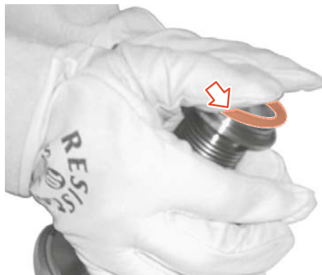
Fig.83: Colocación de la junta de asiento de la válvula en la ranura
