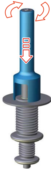
Fig.88: Enroscar la herramienta de impresión
