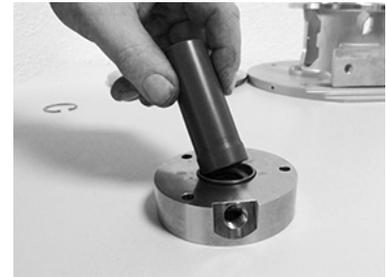
Fig.23: Junta de eje radial
