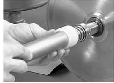
Fig.41: Anillo de deslizamiento
