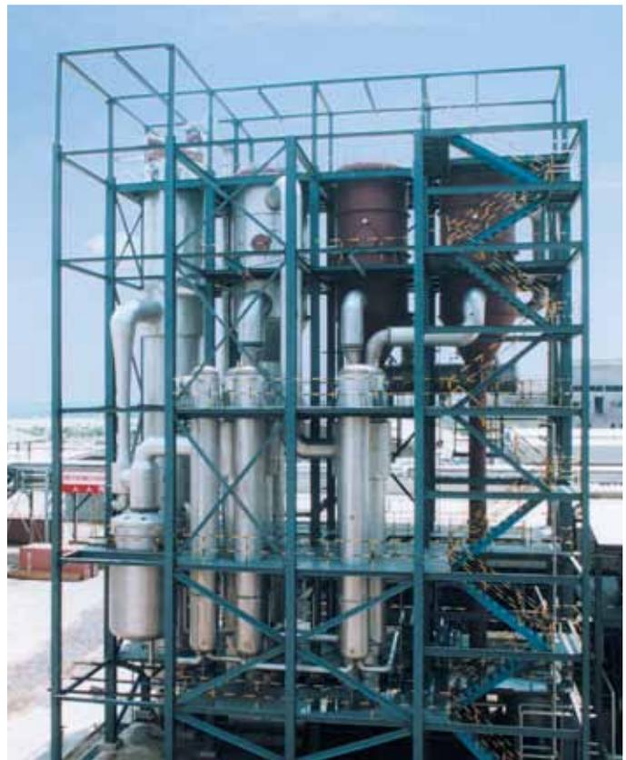
3-stufige Fallstrom-Zwangsumlauf-Eindampfanlage mit thermischer Brüdenverdichtung für Abwasser aus der Natriumglutamatproduktion, Verdampfleistung: 50 t/h
