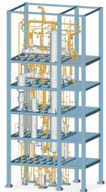
*Fallstrom-/Gegenstrom-Riesel-Eindampfanlage mit Rektifikation zur Veredelung von Olivenöl*
