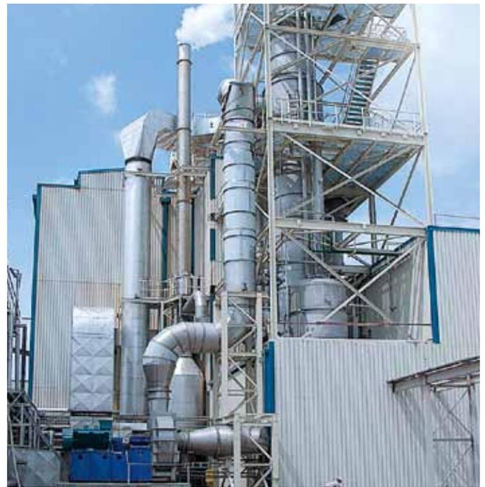
1-stufige Fallstrom-Eindampfanlage mit mechanischer Brüdenverdichtung für Weizenstärkeabwasser, Verdampfleistung: 17.000 kg/h
