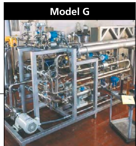
Machbarkeitsstudien im Labormaßstab mit Keramik-, Spiralwickel- oder Hohlfasermembranen im MF- oder UF-Bereich
