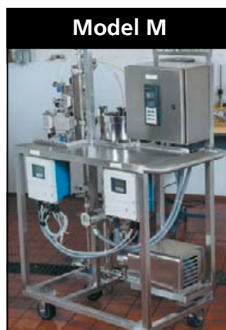
Machbarkeitsstudie im Labormaßstab mit Keramik-, Spiralwickel- oder Hohlfasermembranen im MF- und UF-Bereich
