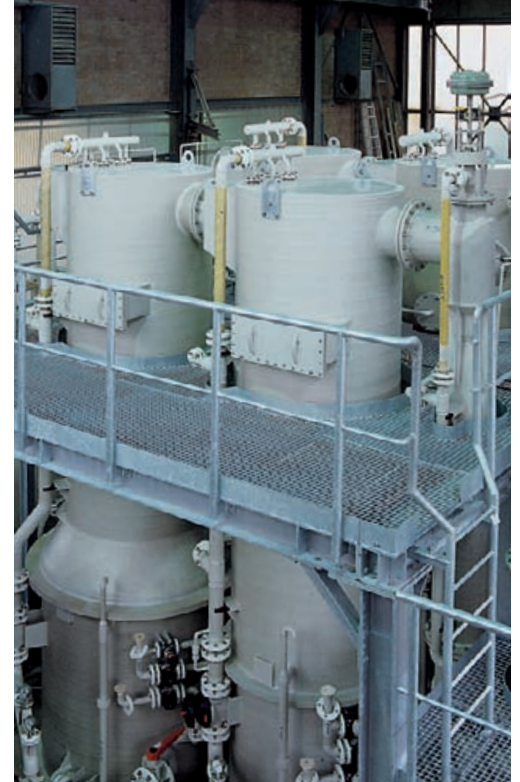
Strahlgaswaschanlage Typ II für saure und alkalische Abgase.
