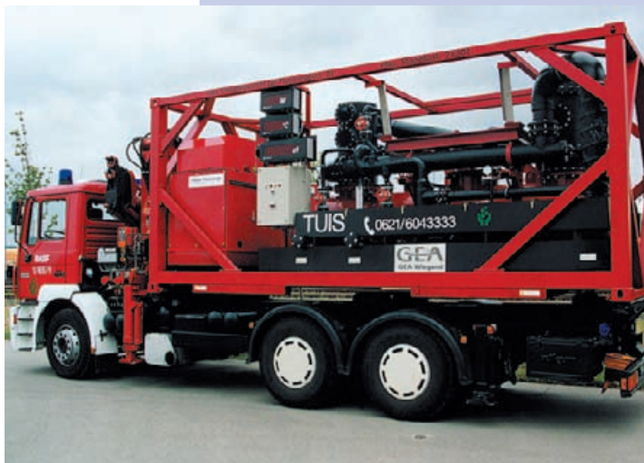
Mobiles Chlornotaggregat im Einsatz.
