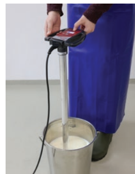
stópka grzewcza z zewnętrznym czujnikiem temperatury
