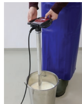
verwarmer met temperatuursensor aan de buitenkant
