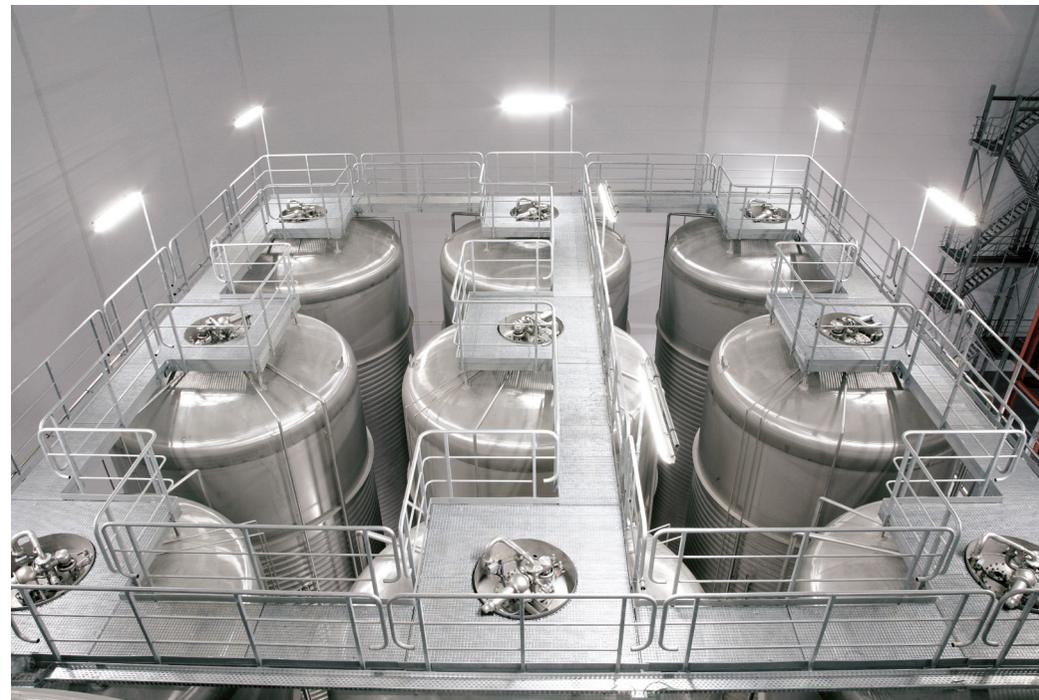
Die modularen VARITOP® Tanksicherungssysteme werden häufig in der Brauindustrie eingesetzt, insbesondere in den Bereichen Gärung und Lagerung.
