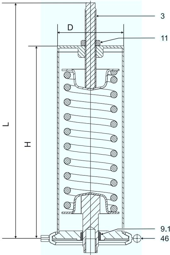
Рис.1: Привод F
