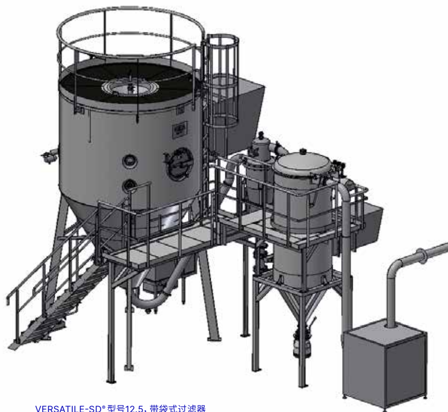
VERSATILE-SD ® 型号12.5, 带袋式过滤器
