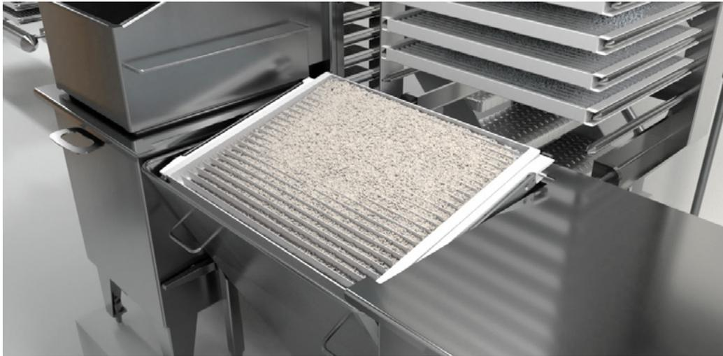
En la estación de vaciado de bandejas, las bandejas con producto liofilizado giran y se vacían por gravedad.
