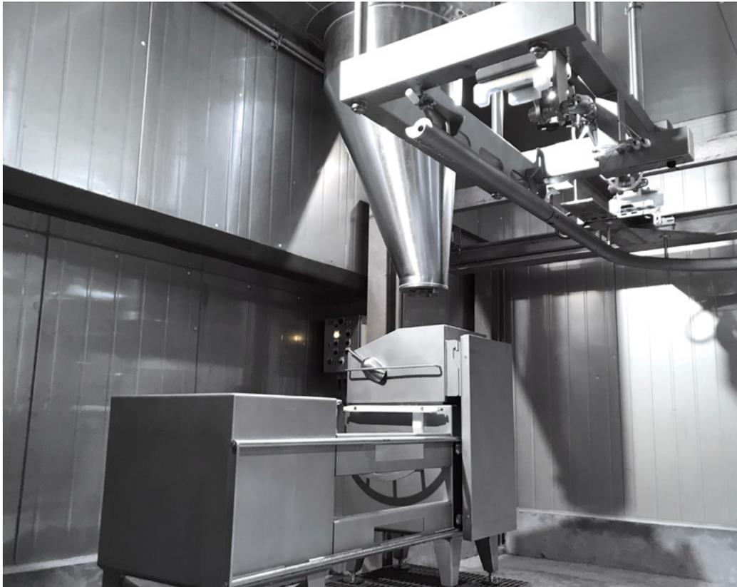
Estación de llenado de bandejas con recipiente intermedio y elevador de carros instalada en una sala a +5 °C.
