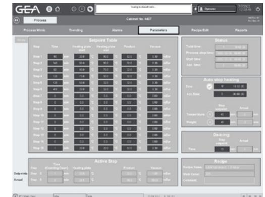
Los parámetros del proceso de liofilización se establecen en recetas almacenadas y seleccionadas desde el sistema de control de la unidad. Todos los datos de temperaturas y presiones se registran en cada ciclo, por lo que la trazabilidad es total. La HMI del sistema es fácil de usar y mantiene disponibles todos los datos clave del proceso.
