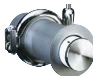
洗浄しないとき、CIPノズルは内壁と同じ面で格納されます。これにより、洗浄ノズルは生産を妨害しません。ノズルはエア駆動仕様もあり、流動層、ダクト、タンクなどを効率的に洗浄します。
