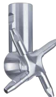
GEAのタンク洗浄装置は、乾燥室と供給タンクの効率的な洗浄を行います。洗浄装置は洗浄水の圧力で駆動し、乾燥室またはタンク内面全体を完全に洗浄します。
