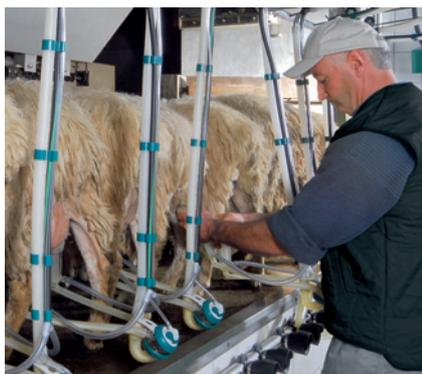
*Turboschnell und einfach melken OviTwin das neue Melkzeug für Anlagen mit hochverlegten Leitungen.*
