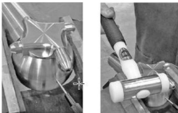
→ Cyclone: 按所示方法, 将旋转壳体 (2) 在台钳中夹紧。用大号可调节扳手拧松喷嘴座 (3)。
