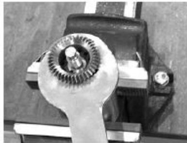
→ La rueda dentada cónica está montada en la carcasa estática.
