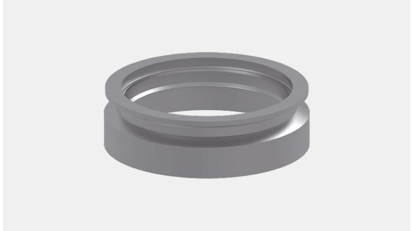
Gehäuseanschlussflansche dienen der tottraumfreien Aufnahme von Messgeräten und werden in die Behälter eingeschweißt. Der Typ U kann am Tankboden oder an Rohraushaltungen installiert werden. Der Typ U-S ist besonders für die Installation in ummantelten Tanks geeignet.
