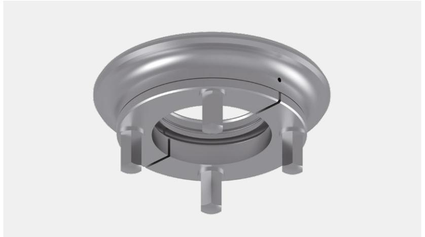
Der Tankanschlussflansch wird in Behältern mit einer Wandstärke von bis zu 20 mm eingeschweißt und nimmt tottraumfrei ein Kontroll- oder Messgerät auf. Über Druckentlastungshalbringe kann der Tankinnendruck kontrolliert entlastet werden.
