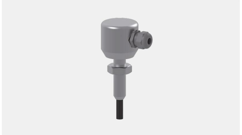
Die Niveausonde arbeitet in Verbindung mit einer handelsüblichen Auswertelektronik auf konduktiver Basis. Die Elektrode wird hauptsächlich in Tanks zur Niveausteuern bei der Behälterbefüllung oder -entleerung eingesetzt. Der beschichtete Elektrodenstab ( $\varnothing$  10 mm) kann beliebig gekürzt werden und dient auch zur Medienerfassung in Rohrleitungen, z. B. als Pumpenschutz. Das erforderliche Anzugsdrehmoment für das Dichtsystem liegt bei 10–20 Nm.
