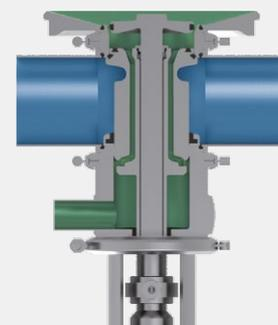
Der obere Ventilteller (Ventilteller-Lift) des Bodenventils kann in Richtung des Tanks angeliftet werden. So ist die Reinigung der Dichtungsflächen und des Leckageraums möglich. Hierzu sollte die Flüssigkeit zuvor in einer ausreichenden Höhe im Behälter angestaut werden.
