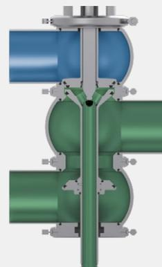
Wenn sich in der unteren Rohrleitung Reinigungsflüssigkeit befindet, ist bei dem Ventiltyp Y ein Anliften des unteren Ventiltellers nach oben möglich.
