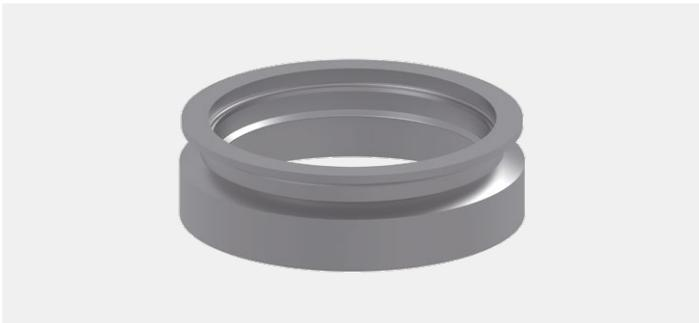
Gehäuseanschlussflansche Typ U und U-S dienen der tottraumfreien Aufnahme von Sitzventilen und werden in die Behälterwandung oder den Behälterboden eines Tanks eingeschweißt. Der Typ U-S eignet sich insbesondere zum Einbau in den Tankboden, da er an die Neigung angepasst werden kann.
