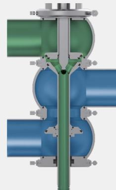
Befindet sich in der oberen Rohrleitung Reinigungsmedium, so ist ein Anliften des oberen Ventiltellers nach oben möglich, um die Dichtungsoberfläche und den Leckageraum abzureinigen.
