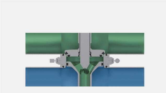
Befindet sich in der oberen Rohrleitung Reinigungsmedium, so ist ein Anliften des oberen Ventiltellers nach oben möglich, um die Dichtungsoberfläche und den Leckageraum abzureinigen.
