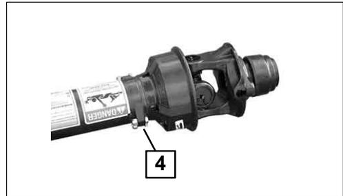
Boulons de cisaillement de remplacement
