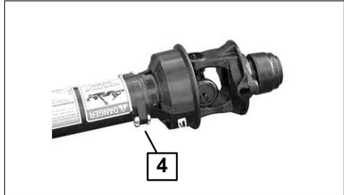
Boulons de cisaillement de remplacement
