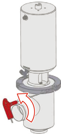
Fig.18: Desserrer la vis du collier de serrage
