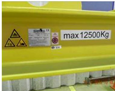
Abb.8: Beispiel - Kennzeichnung Gewicht Lastaufnahmemittel
