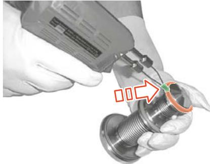
Fig.88: Séparer le joint de vanne à siège
