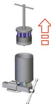
Fig.112: Extraire l'ensemble des ressorts inférieur
