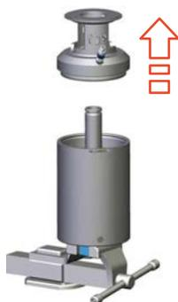
Fig.110: Retirer la partie inférieure de l'actionneur
