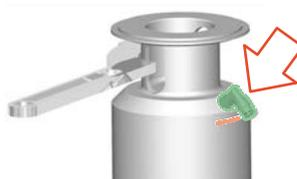
Fig.120: Positionner le raccord d'air
