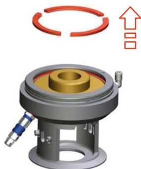
Fig.114: Retirer les éléments de sécurité
