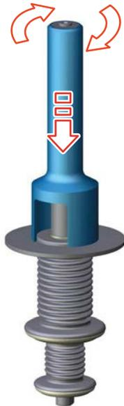
Fig.98: Visser l'outil de mise sous pression
