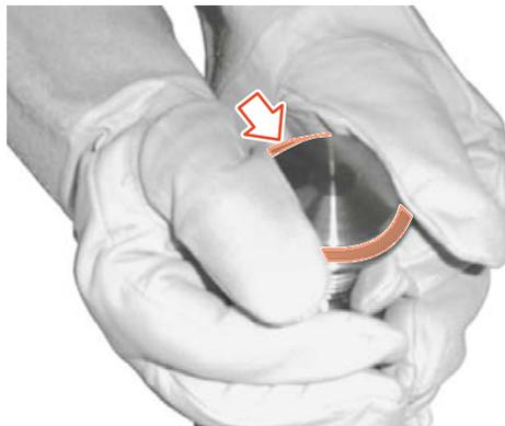
Fig.91: Insérer le joint de vanne à siège
