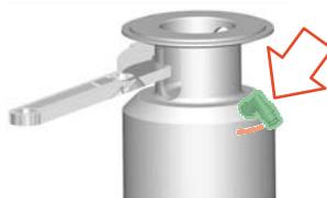
Fig.90: Positionner le raccord d'air
