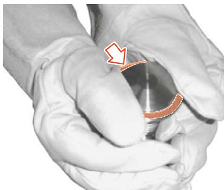
Fig.69: Insérer le joint de vanne à siège
