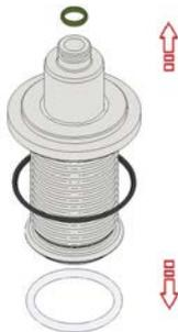
Fig.66: Démontez le soufflet et les joints
