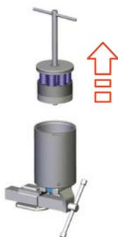
Fig.93: Extraire l'ensemble des ressorts inférieur
