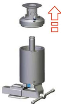
Fig.84: Retirer la partie inférieure de l'actionneur
