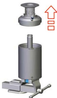
Fig.91: Retirer la partie inférieure de l'actionneur
