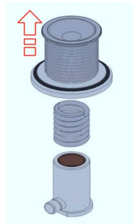
5. Démontez les joints au moyen de *l'outil de montage du joint torique*.
