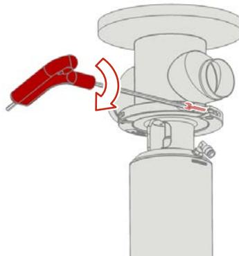
Fig.39: Monter le collier de serrage desserré
