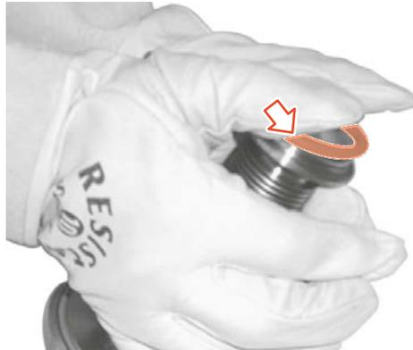
Fig.68: Placer le joint de vanne à siège dans la rainure
