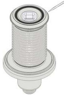
Fig.71: Remplacement du joint trapézoïdal AX
