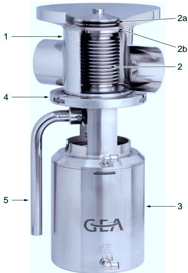
Fig.6: Composants principaux de la vanne
