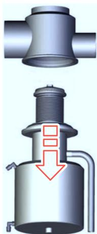
Fig.38: Retirada del accionamiento y de la parte interna
