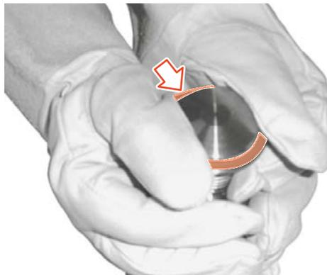
Fig.69: Colocación de la junta de asiento de la válvula
