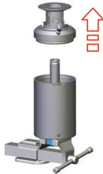
Fig.84: Retirar la parte inferior del accionamiento
