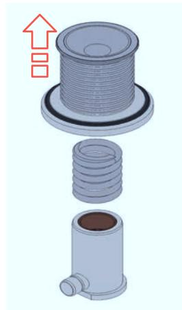
5. Desmontar las juntas con *herramientas de montaje de juntas tóricas*.
