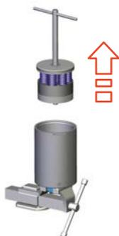
Fig.93: Extraer el bloque de muelle inferior
