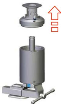
Fig.91: Retirar la parte inferior del accionamiento
