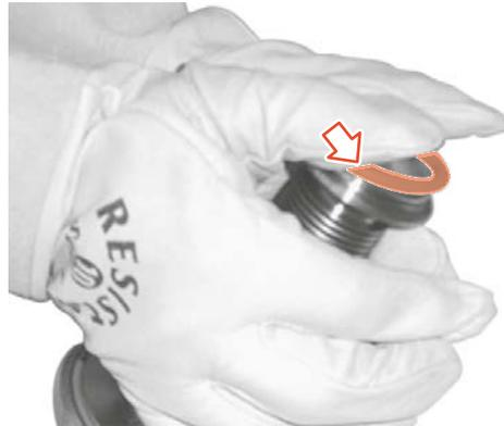
Fig.68: Colocación de la junta de asiento de la válvula en la ranura
