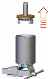
Fig.92: Extraer el bloque de muelle superior
