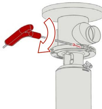
Fig.41: Centrado y sujeción del semianillo
