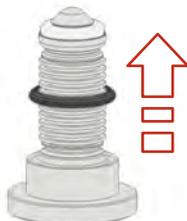
Fig.21: Retirada de la junta de la carcasa
