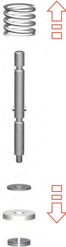
Fig.41: Extracción de los componentes de accionamiento
