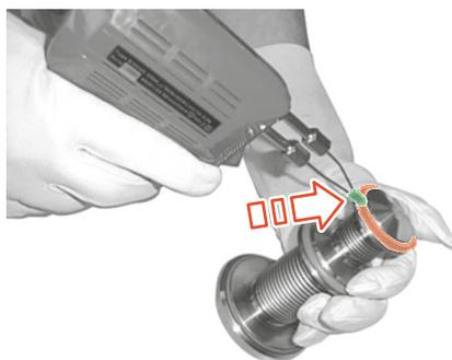
Fig.22: Extracción de la junta del asiento de la válvula
