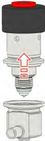
Fig.18: Retirada del accionamiento y de la parte interna
