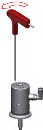
Fig.29: Suelte los tornillos de hexágono interior
