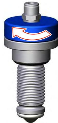
Fig.27: Atornillar la herramienta de extracción
