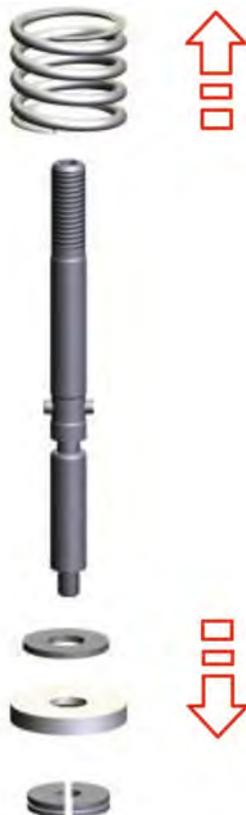
Fig.35: Extracción de los componentes de accionamiento
