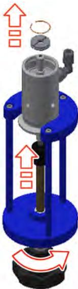
Fig.33: Desprender los componentes del accionamiento
