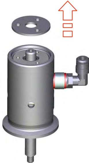
Fig.30: Retirar la arandela de seguridad
