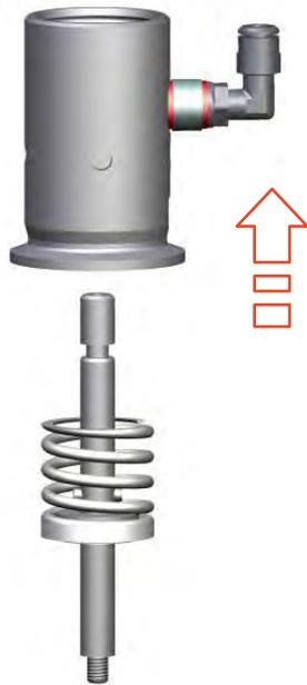
Fig.34: Retirar el cilindro de accionamiento
