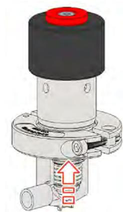
Fig.16: Abrir la válvula NC
