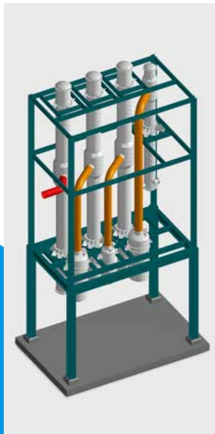
改造前：直接加热的三效降膜蒸发装置
