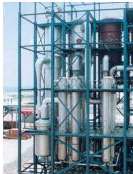
谷氨酸钠生产废水使用的配备热力蒸汽再压缩机的三效降膜强制循环蒸发装置。
