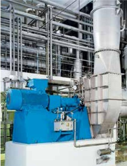
食品生产用单效降膜蒸发装置的机械蒸汽再压缩机（离心风机）
