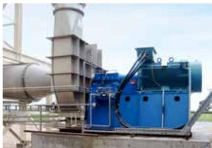
通过叶轮后，蒸汽在螺旋壳体内被输送到排出喷嘴，在那里以较高压力和温度从机器排出。
