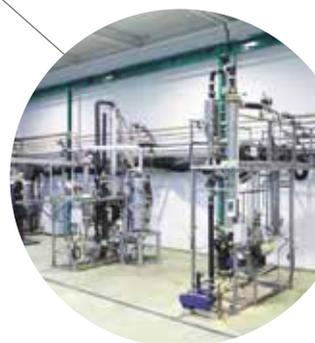
锂正极和负极材料的喷雾干燥器
