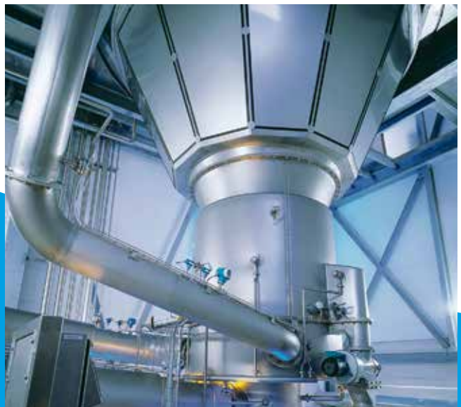
带内置流化床的GEA喷雾冷凝器
