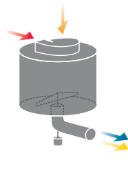
3. 并流式，平底，配有离心雾化器，适于特殊产品，也适于喷雾冷凝。
