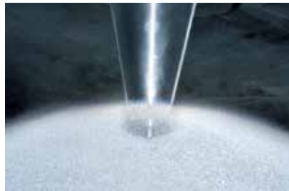
以喷雾冷凝法将融化的脂肪和氢化植物油喷射雾化并最终形成粉末。
