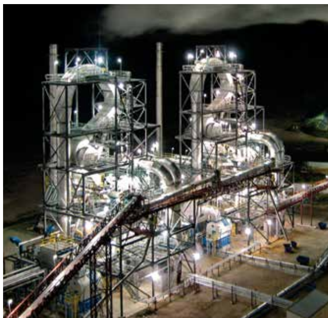
带有部分气体回收的双进料类型环式干燥器
