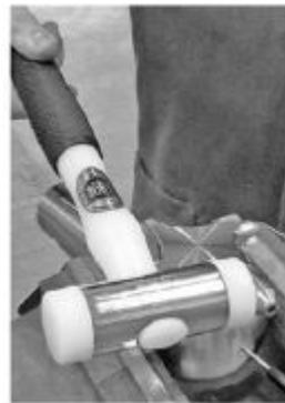
→ Cyclone: Das rotierende Gehäuse (2), wie abgebildet, in einen Schraubstock spannen. Den Düsenträger (3) mit einem großen verstellbaren Schraubenschlüssel lösen.
