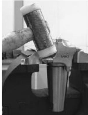
4. Düsenträger gegen den Uhrzeigersinn von Hand lösen und entfernen.
