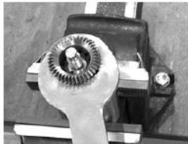
→ Kegelzahnrad ist in statisches Gehäuse eingebaut.
