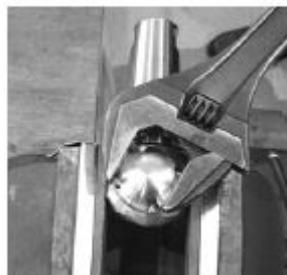
→ Twister: Das rotierende Gehäuse (2), wie abgebildet, in einen Schraubstock spannen. Den Düsenträger (3) durch einen Schlag mit einem Schonhammer lösen.
