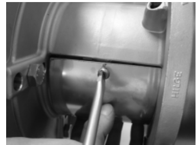
Abb.65: Schutzbleche an der Laterne
