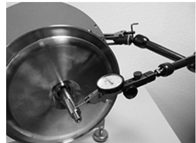
Afb.36: Opmeten van de pompas
