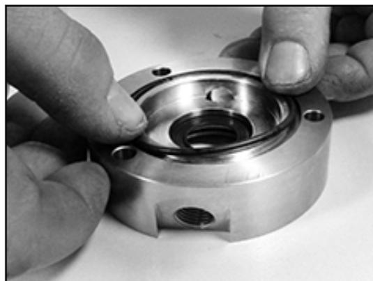
8. Ingrassare le viti a testa esagonale (0901.32) con pasta lubrificante e collegare la guarnizione a cartuccia (0491.00) al coperchio alloggiamento (0161.00). Rispettare le coppie di serraggio a pagina 27.
