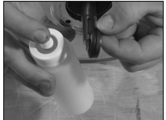
2. Inserire l'anello statico (controanello) della guarnizione ad anello scorrevole (0433.00) nella sede del coperchio dell'alloggiamento (0161.00).
