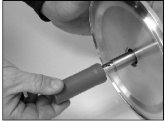
16. Avvitare e serrare saldamente il dado della girante (0922.00) senza la guarnizione tonda. In tal modo si ottiene la giusta lunghezza dell'albero.
