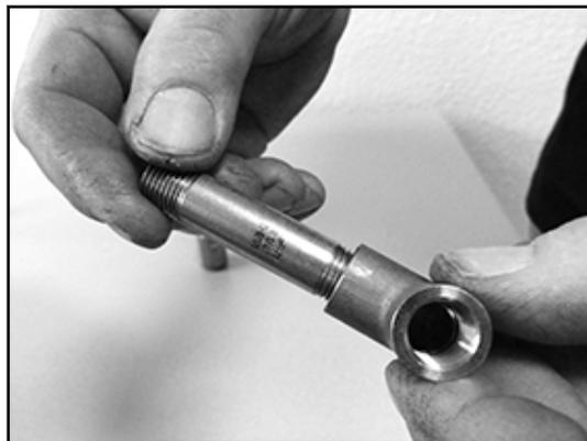
12. Ungere l'altro filetto della tubazione (0736.04) e (0736.05) con Loctite 243 (ad alta resistenza) e collegarlo alla guarnizione a cartuccia (0491.00).
