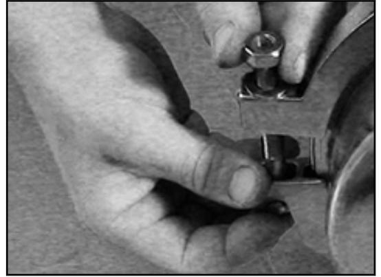
5. Posizionare l'alloggiamento anulare (0103.00) tramite il bocchettone di mandata e una bolla per macchine.
