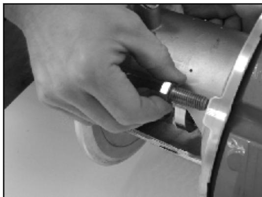
15. Inserire il manicotto di montaggio sull'albero (0211.00) e posizionare il collegamento a morsetto.
