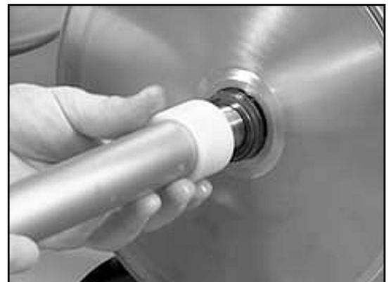
3. Inserire la boccola di montaggio sulla spalla dell'albero.
