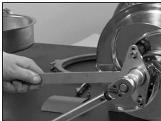
12. In caso di molla conica aperta: scaricare la molla dell'anello di guarnizione (0433.00) contro il disco della guarnizione (0557.00) usando l'espulsore.
