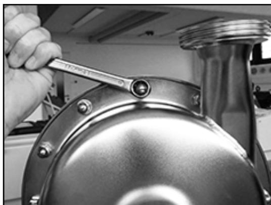
⇒ L'alloggiamento della pompa HPM è montato.
