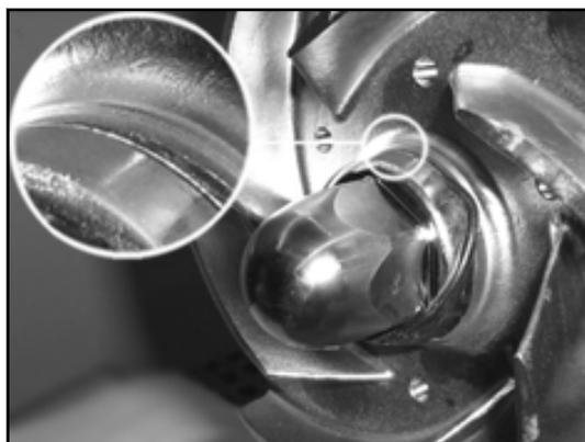
10. Inumidire l'o-ring (0412.04) con acqua e inserirlo oltre il dado della girante (0922.00) nello spazio tra dado della girante (0922.00) e girante (0230.00).
