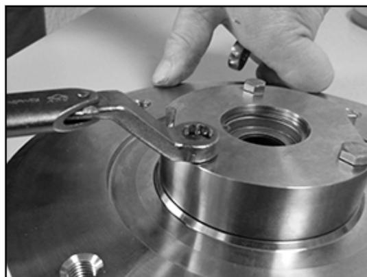
9. Ungere le spine filettate (0902.02) con Loctite 243 e avvitarle fino a battuta nel coperchio alloggiamento (0161.00).
