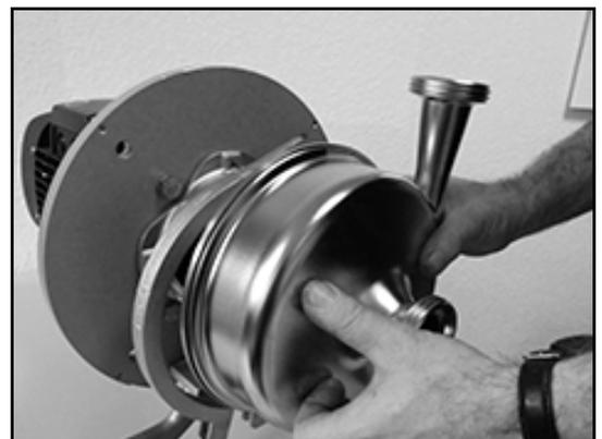
3. Ingrassare l'alloggiamento anulare (0905.00) con Klüberpaste.
