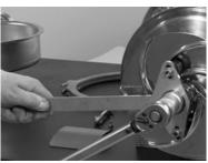
Fig.108: Impeller nut
