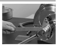
Fig.107: Impeller nut
