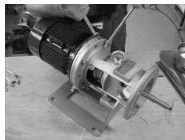
Рис.37: Смонтированная опора подшипника
