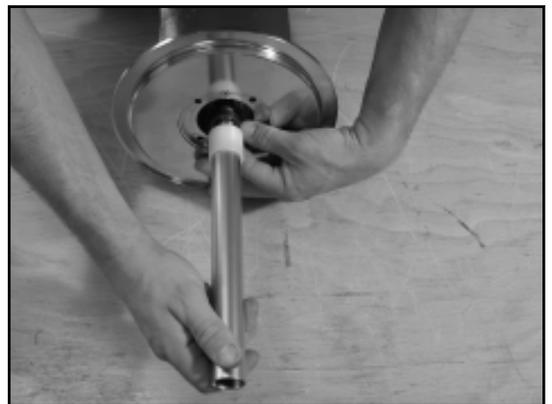
9. Inumidire la boccola di montaggio con acqua pulita e inserire sulla spalla dell'albero.
