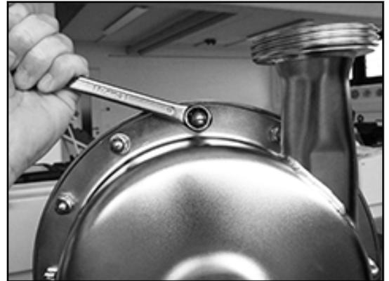
⇒ L'alloggiamento della pompa HPM è montato.
