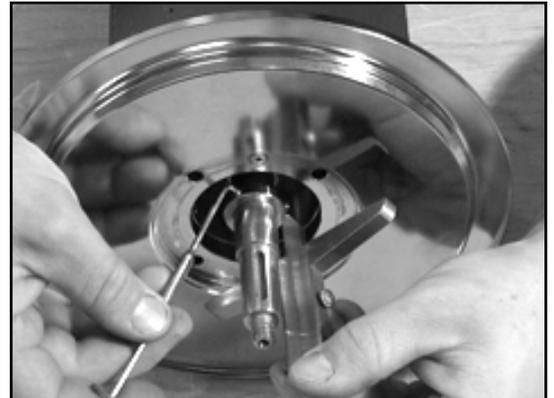
3. Scaricare la molla dell'anello di guarnizione (0433.01) con l'espulsore contro il collare (0516.00).
