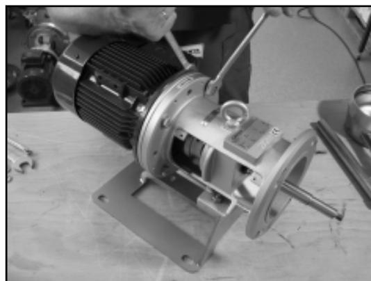
19. Orientare il semigiunto (0840.01) e fissare con il perno filettato (0904.00). Spostamento assiale consentito: 2-4 mm. Rispettare la coppia di serraggio a pagina 27.
