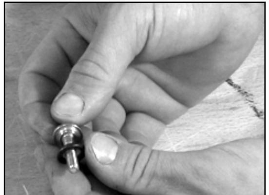
7. Fissare il coperchio della guarnizione (0471.00) con le viti sterili (0918.00) al coperchio dell'alloggiamento (0161.00). Per serrare le viti sterili usare la chiave a bussola con inserto di protezione. Rispettare 3.4.3 *Coppie di serraggio*.
