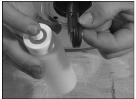
8. Inserire l'anello statico (controanello) della guarnizione ad anello scorrevole (0433.01) con la boccola di montaggio nella sede della cartuccia di tenuta (0491.00).
