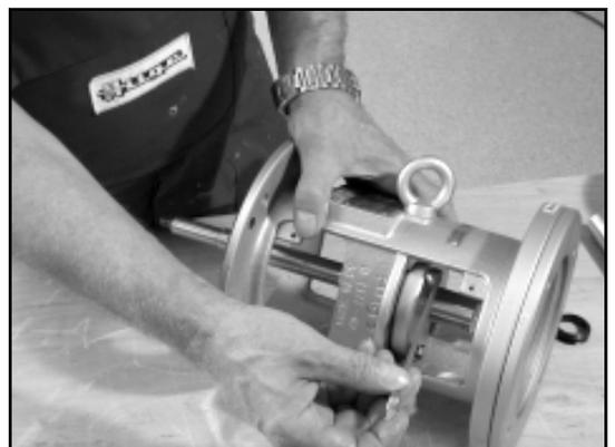
8. Inserire l'anello a V (0507.05) con il labbro di tenuta ingrassato in modo tale sull'albero (0211.00) che il labbro di tenuta poggi sul coperchio del cuscinetto (0360.01).
