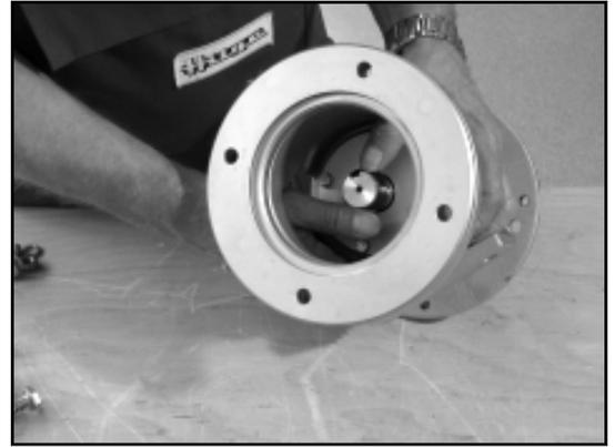
9. Inserire l'anello a V (0507.02) con il labbro di tenuta ingrassato in modo tale sull'albero (0211.00) che il labbro di tenuta poggi sul supporto del cuscinetto (0330.00).
