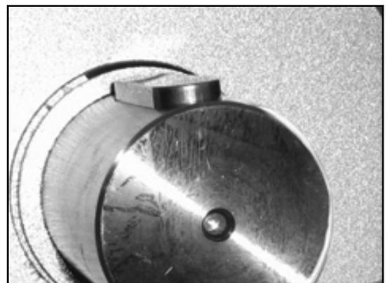
21. Inserire il semigiunto (0840.01) con tampone a filo (0867.02) sull'albero motore e fissarlo con il perno filettato (0904.01), ma solo leggermente.
