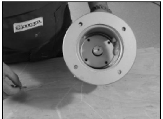
7. Fissare il coperchio del supporto (0360.01) con le rondelle (0554.98) e le viti esagonali (0901.04). Rispettare la coppia di serraggio a pagina 27.
