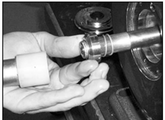
4. Inserire l'anello statico (controanello) della guarnizione ad anello scorrevole (0433.00) nella sede del coperchio dell'alloggiamento (0471.00).
