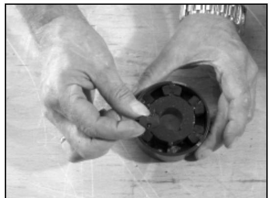
16. Inserire il semigiunto (0840.01) a filo sull'albero motore e fissarlo con il perno filettato (0904.01). Stringere leggermente il prigioniero filettato (0904.01).
