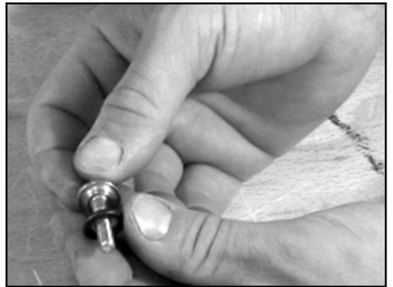
5. Inserire l'o-ring (0412.01) nel coperchio della guarnizione (0471.00).
