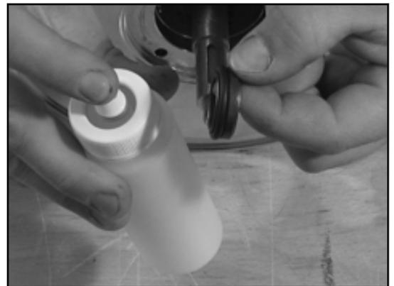
2. Inserire l'anello statico (controanello) della guarnizione ad anello scorrevole (0433.00) nella sede del coperchio dell'alloggiamento (0161.00).
