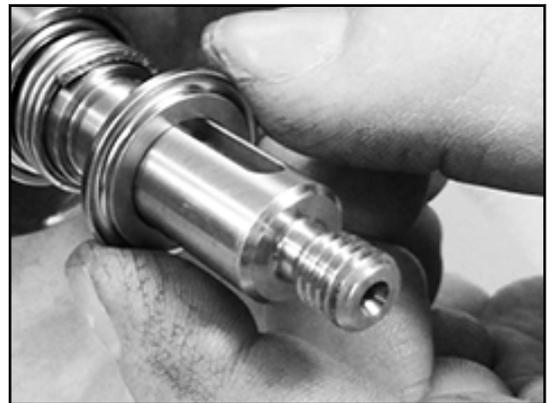
⇒ L'anello di guarnizione semplice con molla conica è montato.
