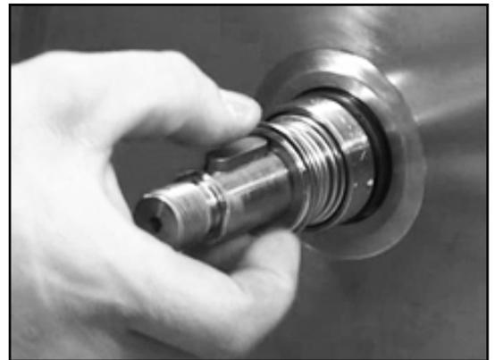
2. Inserire l'o-ring (0412.05) del disco di tenuta (0557.00) oppure nella guarnizione ad anello scorrevole (0433.00).
