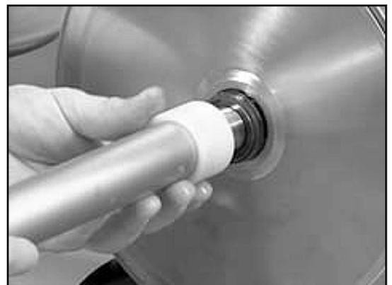
3. Inserire la boccia di montaggio sulla spalla dell'albero.
