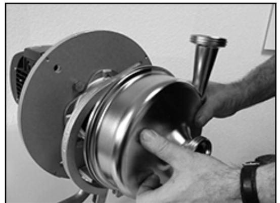
3. Graisser le filetage de l'écrou du rotor (0905.00) avec de la pâte Klüber.
