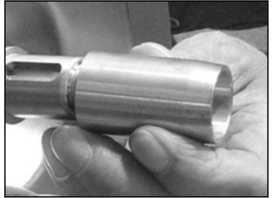
4. Humidifier la douille de montage avec de l'eau propre.
