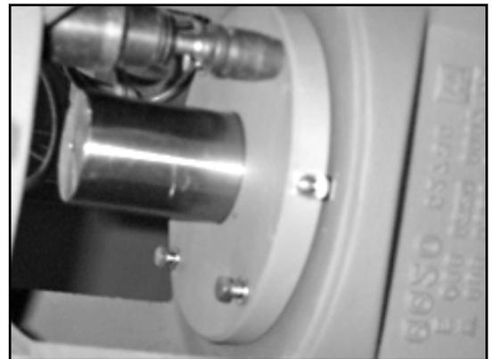
11. Nettoyer le couvercle de palier (0360.00) côté pompe et graisser légèrement sur le côté intérieur.
