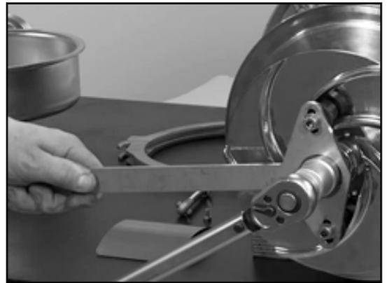
12. En cas de ressort conique ouvert : desserrer le ressort de la garniture mécanique (0433.00) contre la rondelle d'étanchéité (0557.00) avec l'éjecteur.
