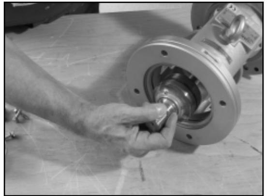
6. Graisser légèrement le couvercle de palier (0360.01) sur le côté intérieur et le glisser sur l'arbre (0211.00).
