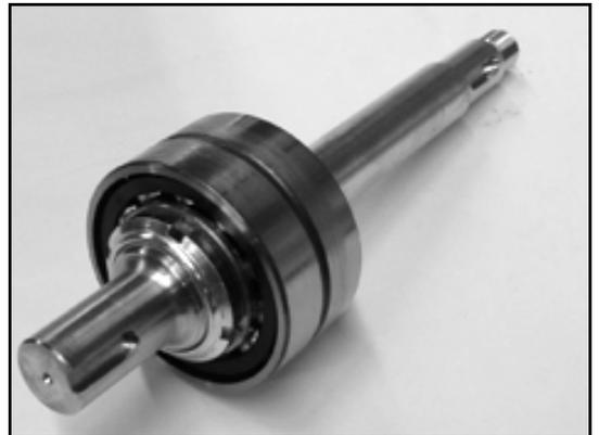
4. Remplir entièrement les espaces des paliers à roulements (0326.00) avec de la graisse. Respecter *Quantités de graisse pour les supports de palier ADAPTA tailles 1 et 2.*
