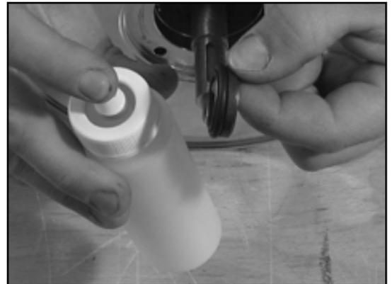
2. Glisser l'anneau opposé de la garniture mécanique (0433.00) dans le siège du couvercle du logement (0161.00).
