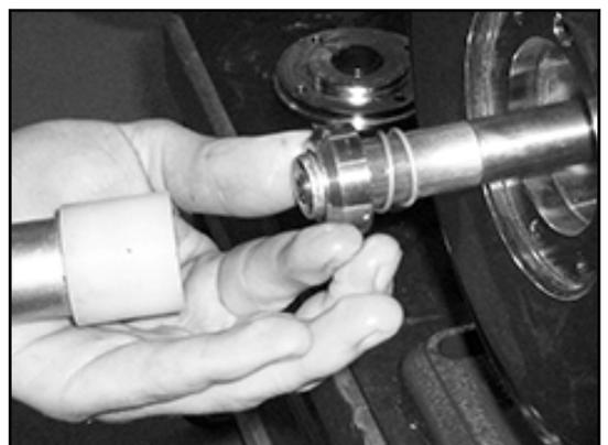
4. Mettre l'anneau fixe (anneau opposé) de la garniture mécanique (0433.00) dans le siège du couvercle d'étanchéité (0471.00).
