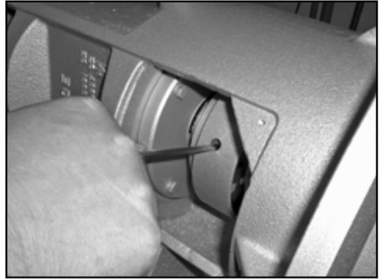
18. Graisser les goujons (0902.06) avec de la pâte Klüber UH1 96-402 et les visser dans le support de palier (0330.00).
