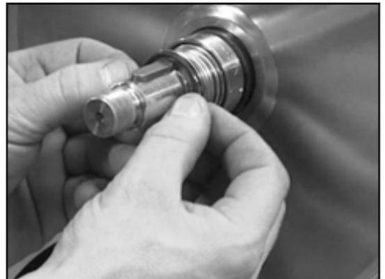
3. Graisser le siège du rotor et le filetage de l'arbre avec de la pâte Klüber.
