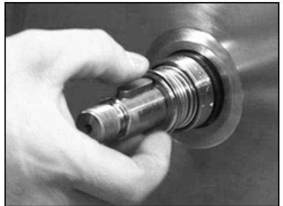
2. Poser le joint torique (0412.05) dans la rondelle d'étanchéité (0557.00) ou la garniture mécanique (0433.00).
