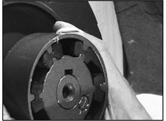
22. Emboîter les moitiés d'accouplement (0840.01) et (0840.00) et raccorder le moteur (0801.00) et le support de palier (0330.00)
