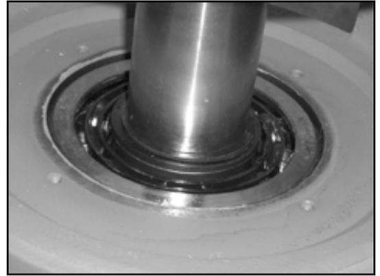
9. Nettoyer le couvercle de palier (0360.01) côté moteur et graisser légèrement sur le côté intérieur.
