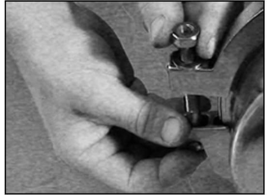
5. Aligner le logement du joint (0103.00) sur la tubulure de refoulement à l'aide d'un niveau à bulle pour machine.
