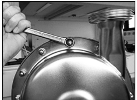
⇒ Le corps de pompe à bride haute pression est monté.
