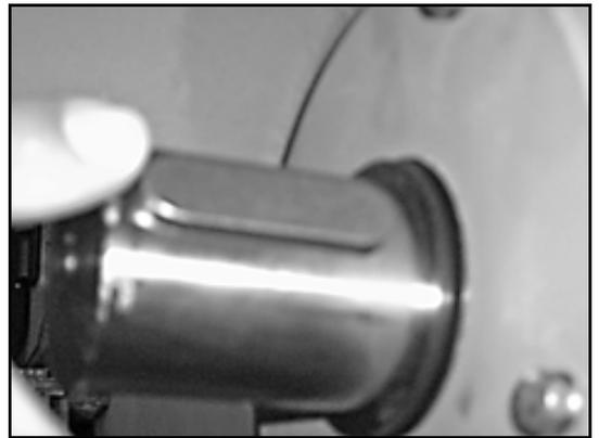
15. Graisser le siège de l'accouplement sur l'arbre (0211.00) avec de la pâte Klüber UH1 96-402.
