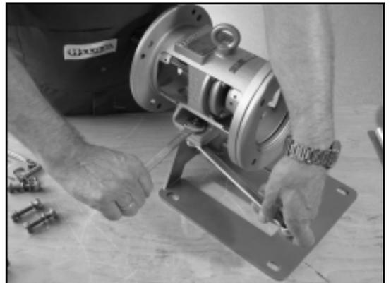
14. Mettre les clavettes (0940.01) dans l'arbre du moteur.
