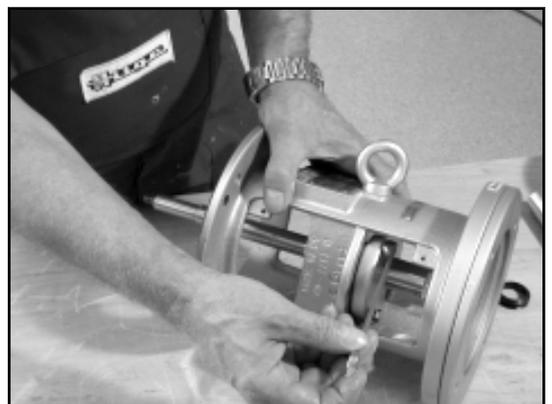
8. Glisser le joint trapézoïdal (0507.05) avec la lèvre d'étanchéité graissée sur l'arbre (0211.00) de manière à ce que la lèvre d'étanchéité se trouve sur le couvercle de palier (0360.01).
