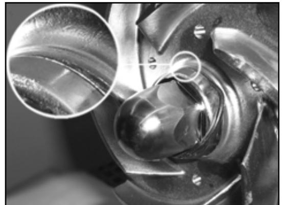
10. Humidifier le joint torique (0412.04) avec de l'eau et le glisser sur l'écrou du rotor (0922.00) dans l'espace entre l'écrou du rotor (0922.00) et le rotor (0230.00).
