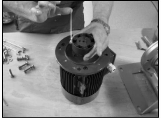
17. Raccorder le moteur au support de palier (0330.00). Emboîter les deux moitiés d'accouplement (0840.00, 0840.01).
