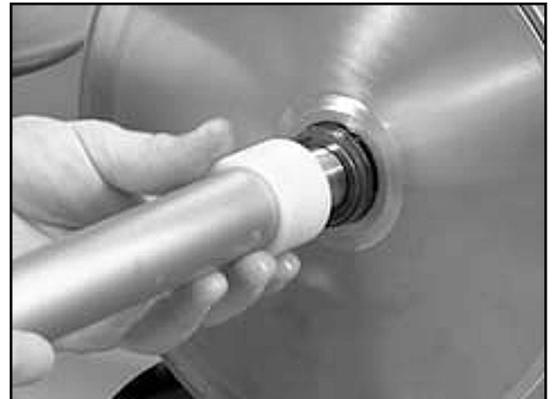
3. Glisser la douille de montage sur le palier d'arbre.
