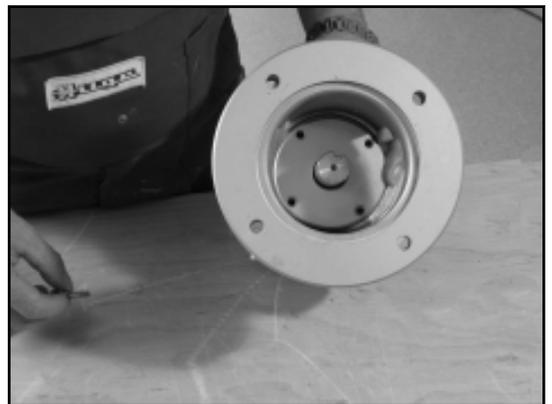
7. Fixer le couvercle de palier (0360.01) avec les rondelles (0554.98) et les vis à tête hexagonale (0901.04). Respecter le couple indiqué à la page 27.
