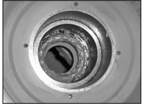
4. Chauffer le roulement à billes oblique (0326.00) à 110-115 °C.
