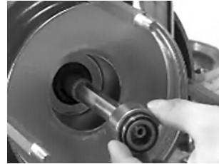
Abb. 61 Rotierender Gleitring der Gleitringdichtung MF-469
