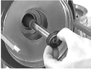
Abb. 60 Feststehender Ring der Gleitringdichtung, Druckgehäuse MF-466
