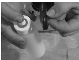
Abb. 58 Feststehender Ring der Gleitringdichtung
