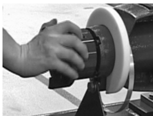
Rys. 3 Sprawdzenie wału pompy
