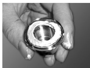
Rys. 6 Podkładka Nord-Lock w nakrętce wirnika
