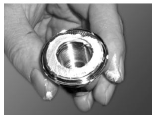
Рис. 26 Зубчатая стопорная шайба в гайке рабочего колеса
